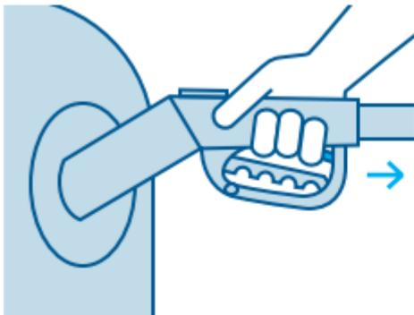
Verriegelung in Pfeilrichtung ziehen: Griffhebel löst sich.
