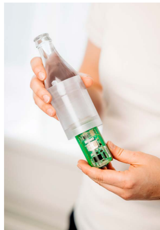
Senzor umetnut u simulacijsku bocu registrira moguće točke opasnosti za stakleni spremnik na liniji.
