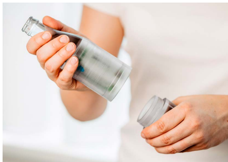
Senzor umetnut u simulacijsku bocu registrira moguće točke opasnosti za stakleni spremnik na liniji.
