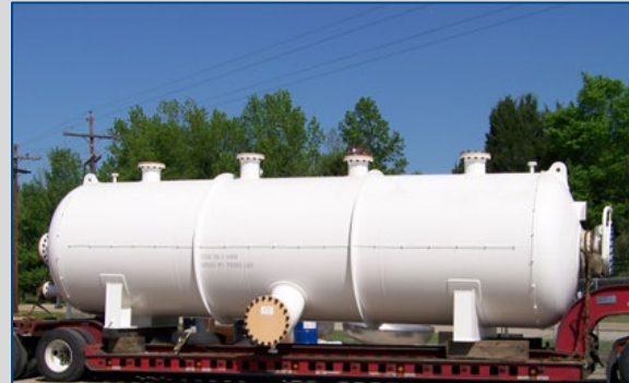
International LNG project core-in-kettles
