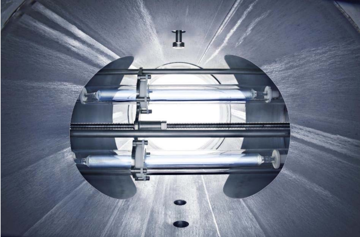
Reaktor einer Wasseraufbereitungsanlage
