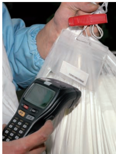
原材料の小分け袋に取り付けたICタグの読み取り風景
