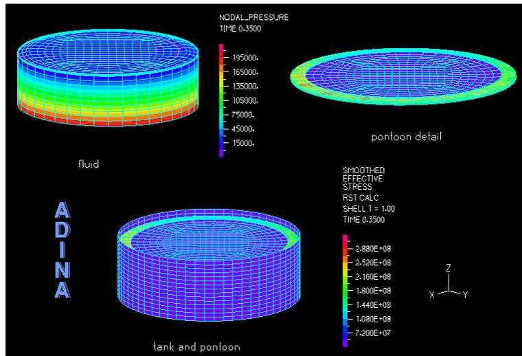
Didascalia: Analisi dello sloshing all'interno di un serbatoio di petrolio con la base soggetta a movimentazione orizzontale del terreno utilizzando il software ADINA.
