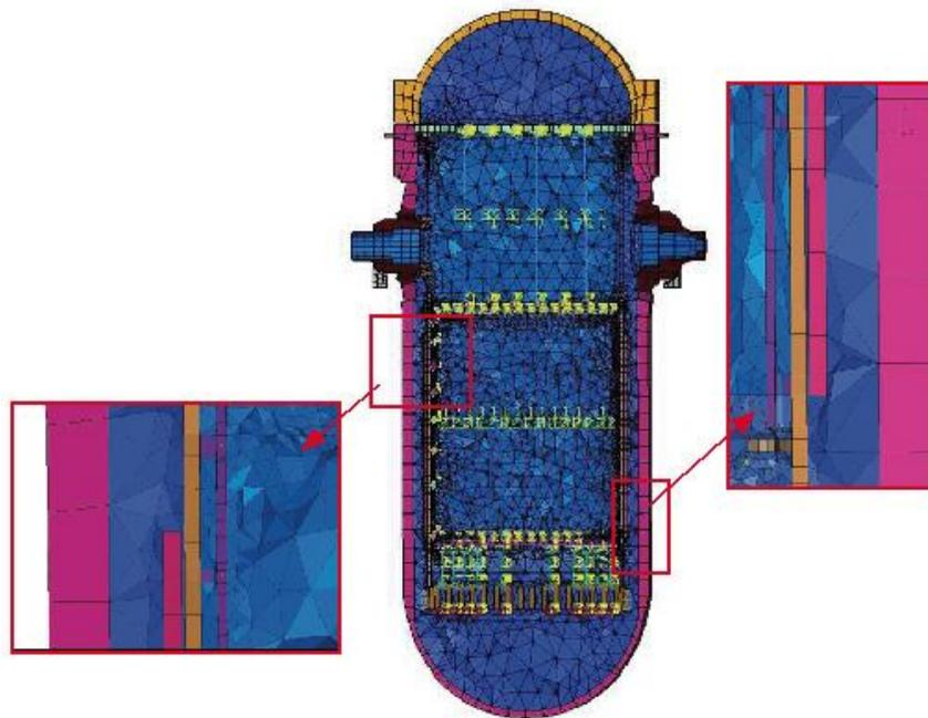
Didascalìa: Simulazione della rottura di una tubatura in un reattore nucleare con l'aiuto della tecnologia ADINA.
