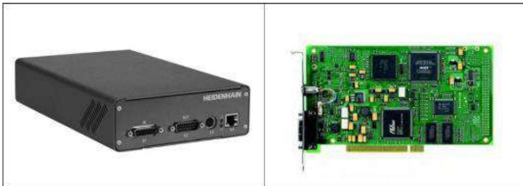
- Interfețe de achiziție de date pentru diagnosticarea sistemelor de măsură de tip encodere și rigle optice și anume produsele PWM20 și IK215 de la Heidenhain și PGT11 de la Sick
