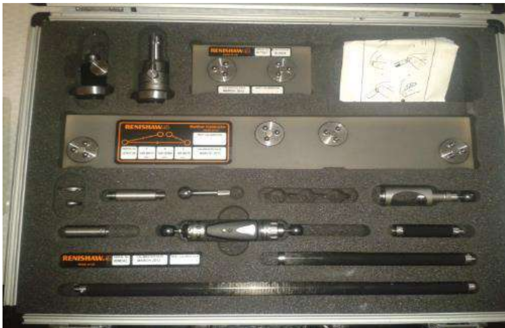
c. Analiza calitativă a geometriei axelor mașinii unelte, realizată cu ajutorul trusei BallBar Renishaw QC20.
